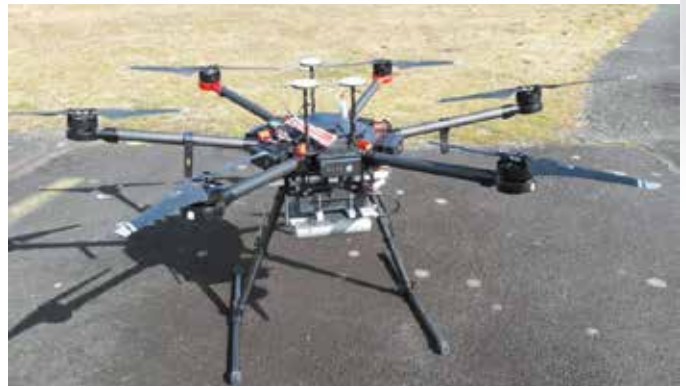
Drone DJI avec spectromètre portable et système de communication associé
