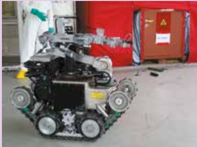
EOLE en chemin vers une cellule de retraitement de combustible accidentée et prêt à actionner un bouton d'urgence
